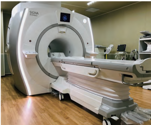
DWIBS検査を行う3.0T MRI装置
